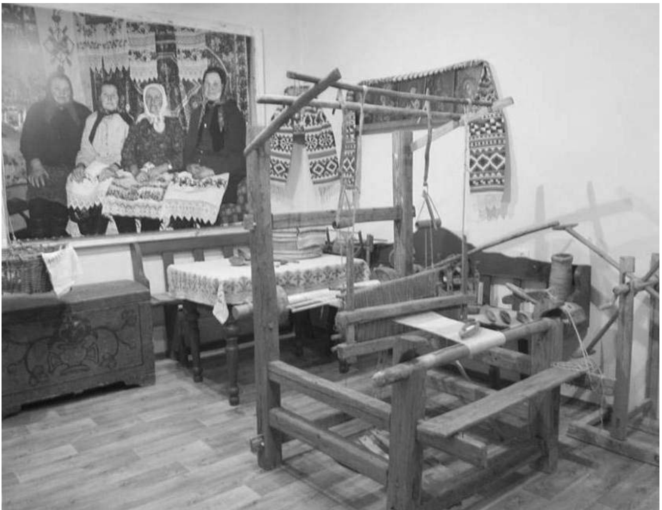
Верстат, на якому заготовлено ткани рушників, справа – вертикальна снувалка.
